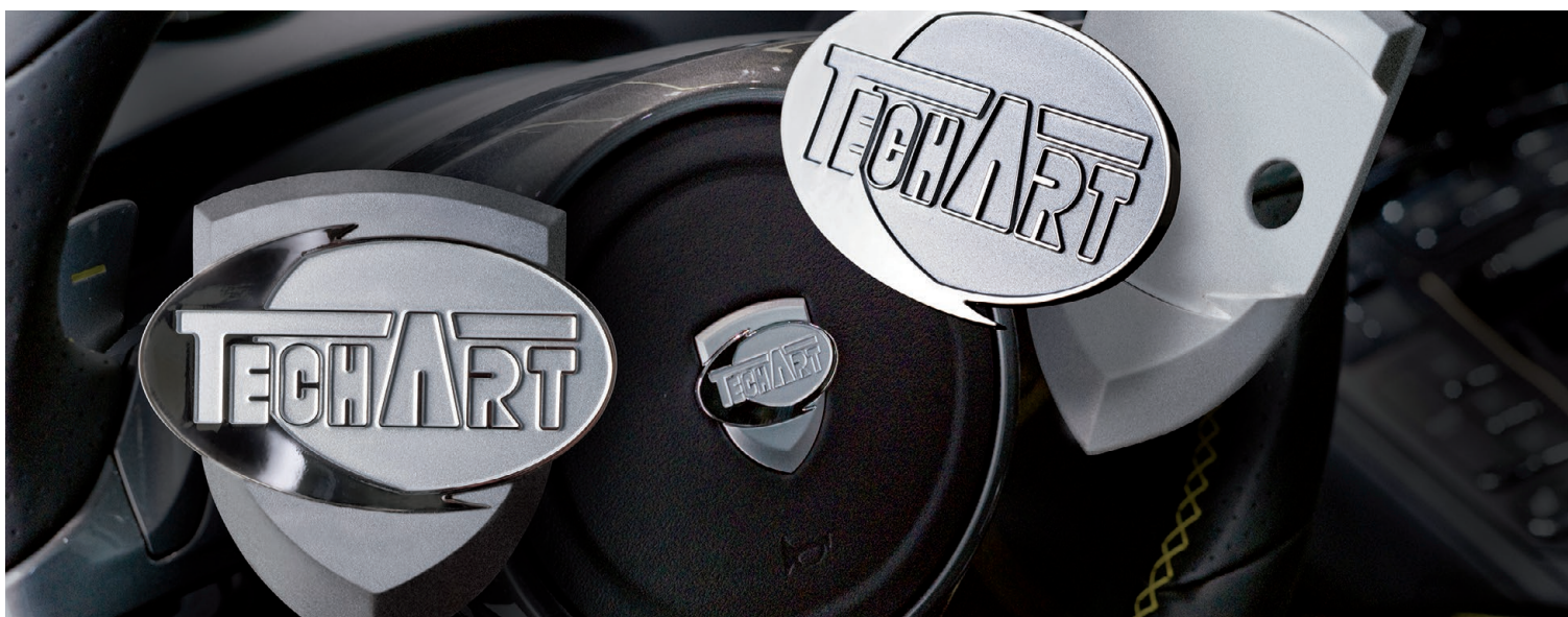
Durch die zweiteilige Konstruktion konnte das TechArt-Emblem perfekt an die Aussparung des Porsche-Emblems angepasst werden
